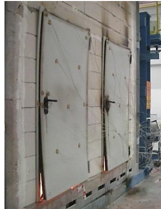
شکل ۷-۸ عملکرد ناصحیح در آتش در نتیجه نصب نادرست
