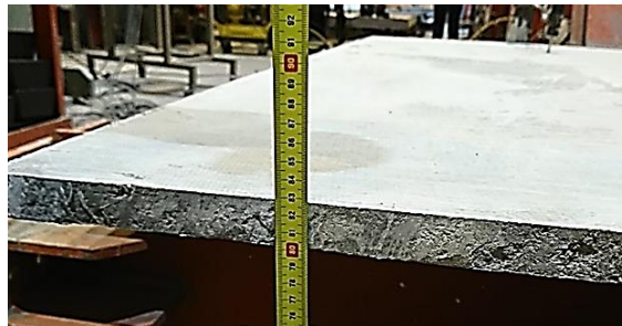
شکل ۲-۳۴ ضخامت پانل کامپوزیتی
