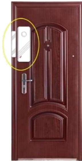
شکل ۸-۱۵ سنجه تشخیص باز شدن درها
