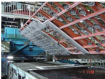
شکل ۸-۱ لایه اول پانل دیوار در حال فرود روی لایه دوم
