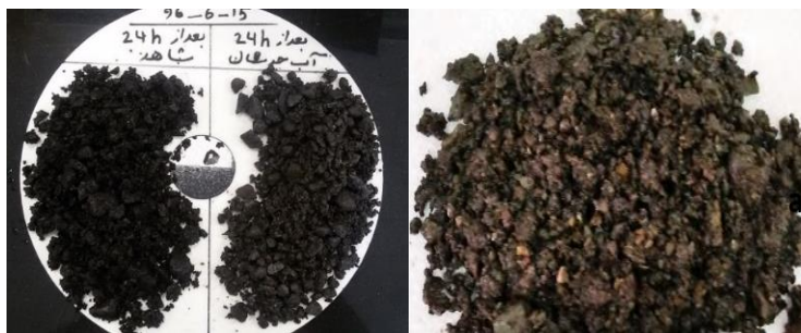
شکل ۴-۲۱ آزمایش آب جوشان بر روی نمونه کنترل و نمونه حاوی قیر پودر لاستیک
