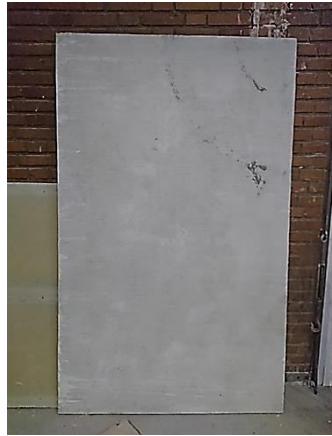
شکل ۲-۳۳ پانل کامپوزیتی متشکل از پارچه سه بعدی شیشه، پر شده با ملات سیمانی
