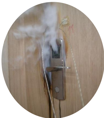
شکل ۶-۷ عملکرد ناصحیح درهای مقاوم در برابر آتش در نتیجه استفاده از مصالح ساخت نامرغوب
