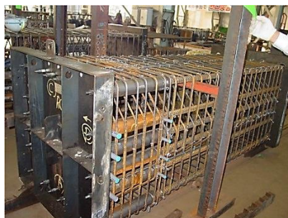
شکل ۱-۳۲ جزئیاتی از سیستم سازه‌ای R-PC به عنوان قاب خمشی بتن مسلح
