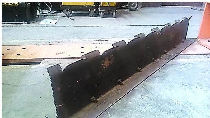
شکل ۲-۷ تصویر تیرچه فولادی از ورق خم شده
