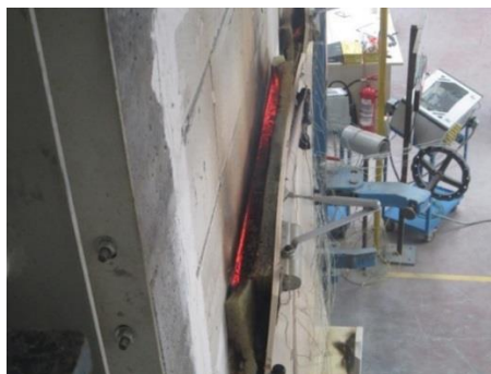
شکل ۷-۷ عملکرد ناصحیح در آتش در نتیجه طراحی غیراصولی
