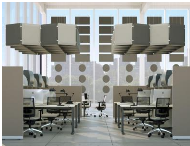
شکل ۶-۳ استفاده از بافل‌ها در سقف
