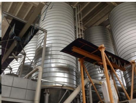
شکل ۲-۴ سیلوهای نگهدارنده گرانول
