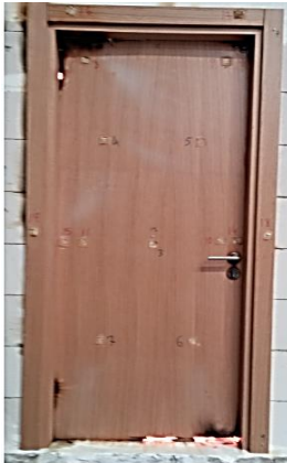
شکل ۷-۸ عملکرد ناصحیح در آتش در نتیجه نصب نادرست
