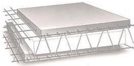
شکل ۳-۳ پانل‌های غیر-سازه‌ای نیمه پیش ساخته سه بعدی
