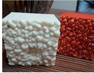
شکل ۶-۸ پلی یورتان صلب پاششی اجرا شده
